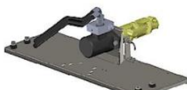
Nezávislý pohon diskov hydromotorom
