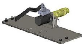
Nezávislý pohon diskov hydromotorom
