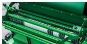
Pre sériu lisov s variabilnou komorou McHale bol navrhnutý a vyvinutý vysoko výkonný napínač sieťky.
