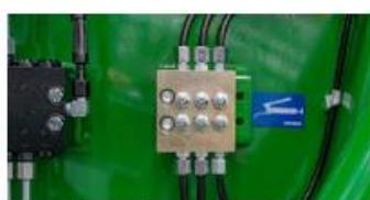
Centralizovaný mazací box všetkých ložísk. Za príplatok možnosť automatického mazania.
