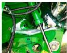
Hydraulicky sklopná podlaha komory umožňuje veľmi rýchle a jednoduché odblokovanie balíka
