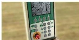
McHale V6740 a V6750 sú vybavené riadiacou konzolou Expert Plus s veľkým grafickým displejom. Konzola Expert Plus dáva operátorovi na výber mäkkého alebo tvrdého jadra balíka v závislosti na požiadavkách zákazníkov.
