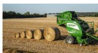
Lisovacia komora v rade lisov s variabilnou komorou McHale sa skladá z nekonečných pásov pre vysoké zataženie. Pásy sú mimoriadne odolné a sú vystužené syntetickým materiálom.
