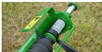
Hydraulicky ovládaný systém vykonáva strihanie a navádzanie fólie v pozícii pripravené pre balenie ďalšieho balíka.
