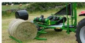
Baliaci stôl baličky okrúhlych balíkov 991BC je vybavený štyrmi silnými pásmi, ktoré zaisťujú bezproblémové a rovnomerné otáčanie balíkov
