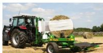
Baliaci stroj okrúhlych balíkov 991BC je vybavený funkciou automatického zastavenia. Po začatí procesu balenia bude baliaci stôl pracovať až do doby, než sa dosiahne vopred nastaveného počtu otáčok. Po dokončení balenia sa stôl automaticky zastaví vo vyklápacej pozícii a balík je tak preklopený zo stola jednoduchým zatiahnutím za páku.
