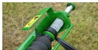
Hydraulicky ovládaný systém vykonáva strihanie a navádzanie fólie v pozícii pripravenej pre balenie ďalšieho balíka.
