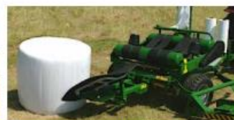
Bočné odkladanie je výbava na želanie pri všetkých modeloch baličiek McHale 991B. Táto funkcia umožňuje postavenie balíkov na ich čelo po dokončení balenia.
