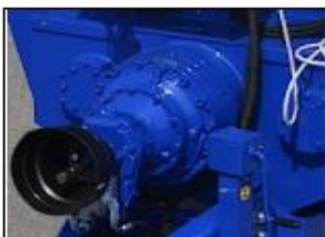
Robustná redukčná prevodovka RBS Brevini 2215
