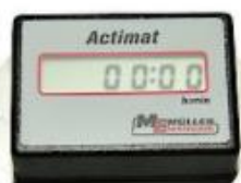
Počítadlo hodín na základe vibrácií stroja
