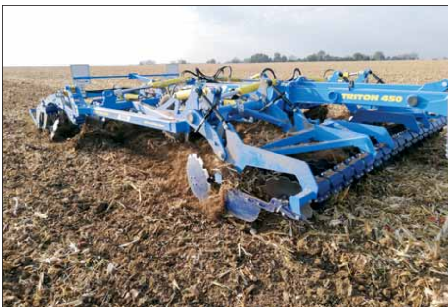
Pri technológiách založených na vertikálnom obrábaní pôdy radličkovým náradím dochádza k rovnomernému zamiešaniu pozberových zvyškov s pôdou.
