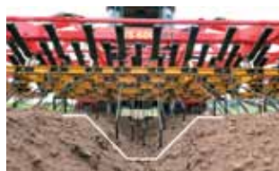
Kopírovací mechanizmus Vario Striegel v zemiakoch.
