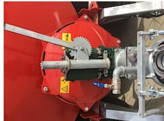
Nerezový ventil je umiestnený v zadnej časti cisterny.
