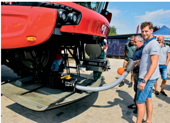
Čerpadlo s výkonnosťou 1 500 l za minútu, ako ukazuje Ing. Ján Lajda, naplní 8 000 l nádrž v priebehu 5 a pol minúty.
