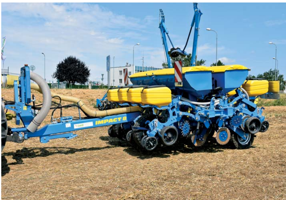
Sejačka na presný výsev Farnet Impact s prihnojovaním.
