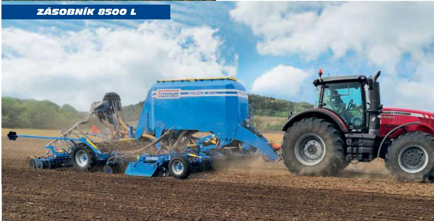
**Dvoukomorový zásobník** s navýšeným objemem pro vysokovýkonné setí s aplikací hnojiva. Možný výsev dvou plodin. Minimalizace ztrátových časů plnění. Snadné plnění. Vysoká stabilita díky dimenzovanému pneumatikovému válci.
