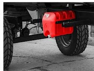
Nádrž na vodu a dávkovačom mydla
