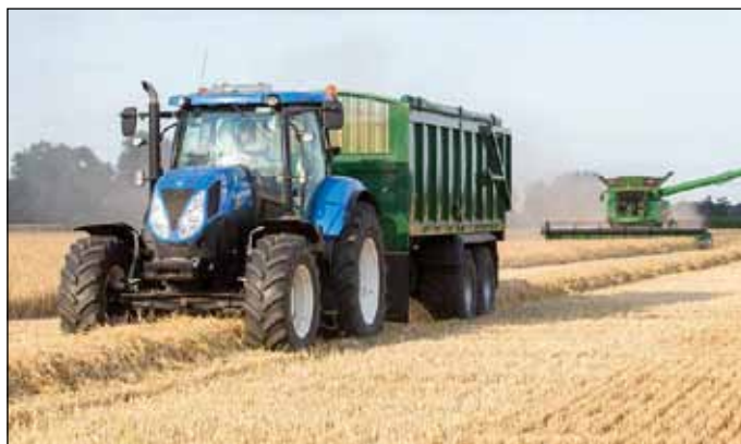
Riadený pohyb mechanizmov po poli je dôležitý z hľadiska zníženia dopadov utlačenia pôdy.
