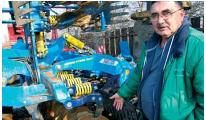
Každý tanier je uchytený a istený samostatne. Okrem toho, že je tu zaistené dokonalé kopírovanie terénu, v prípade potreby výmeny nejakého vymeniteľného dielu, napr. ložiska, nie je potrebné rozobrať celú sekciu, ale len konkrétne rameno.
