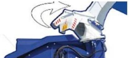
Smerovanie materiálu je možné meniť vďaka vyfukovacej koncovke otočnej o 270 stupňov a vďaka klapke aj vpravo dole.
