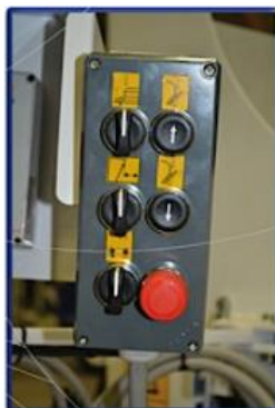
Elektronické ovládanie miesto bowdenov
