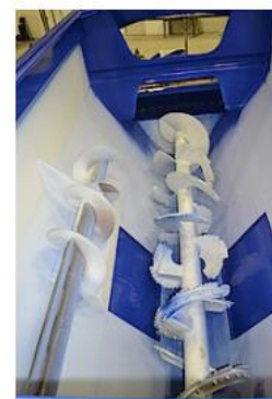
Skrutkovice sú protichodné a sústreďujú miešanie od krajov do stredu - hore a následne pomocou horného šneku späť do krajov.
