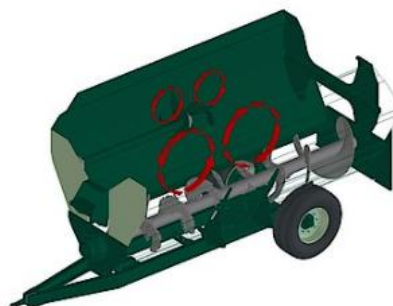
Systém jedného spodného lopatkového šneku a jedného horného rozhrňovacieho šneku.
