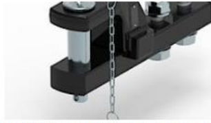
Pripojenie strojov do spodného tiahla
