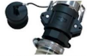
Hadicová spojka pre komfortnejšie odpojenie stroja
